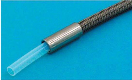
Wir empfehlen PTFE, wenn Sie eine hohe Haltbarkeit wünschen und die Anwendung eine hohe chemische Beständigkeit erfordert. Der Schlauch ist mit einem glatten Innenschlauch aus PTFE ausgeführt und es wird ein Außengeflecht aus Edelstahl (für die Norm AISI 304 – auf Anfrage 316L erhältlich) verwendet. Wir produzieren auch Hochleistungsschläuche mit Innenrohren aus anderen Fluorkunststoffen wie PFA und ETFE oder mit einer Ummantelung aus Hytrel®.
